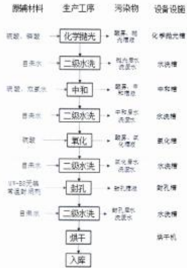
手动铝氧化线工艺及产污环节图
