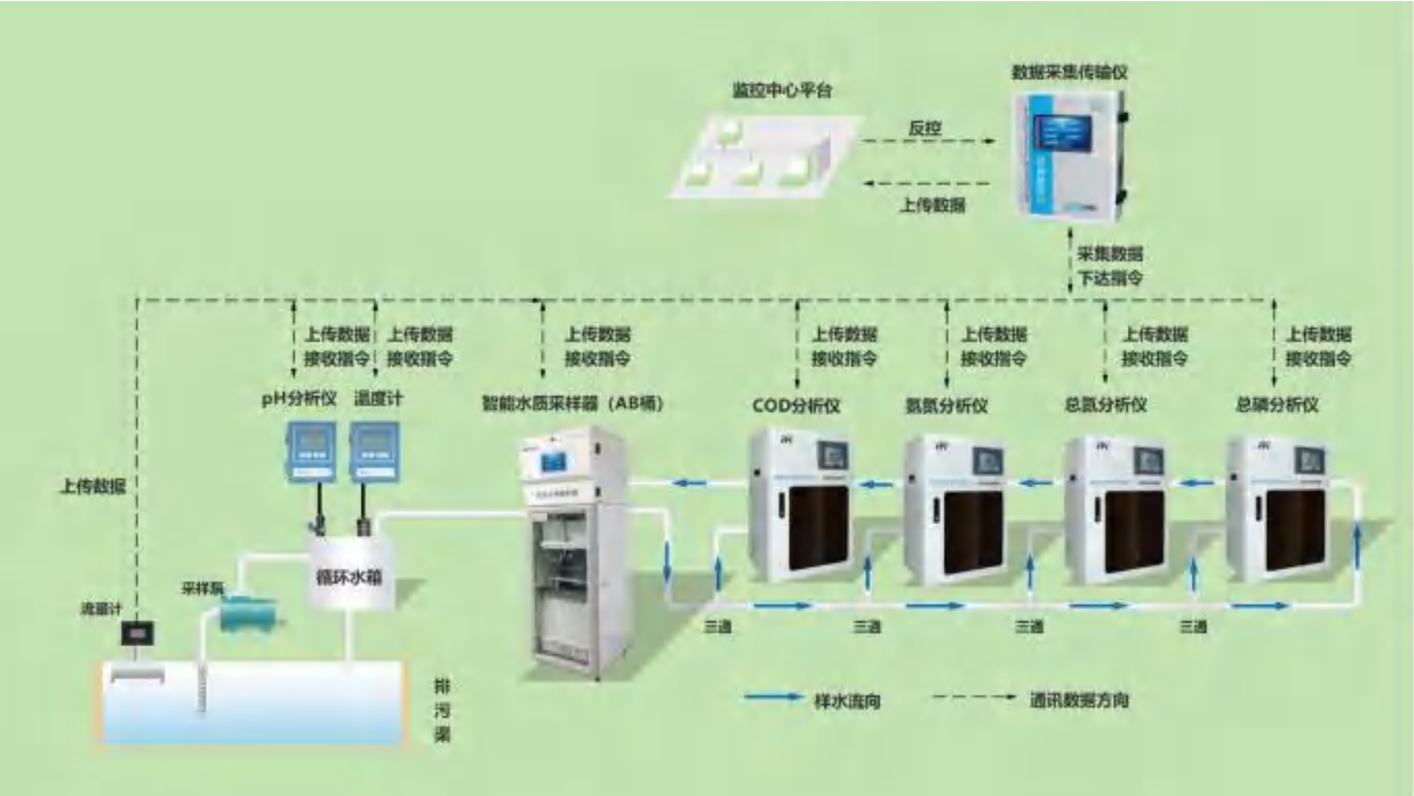
附件 3 水污染源在线监测系统构成图及单元流路图
