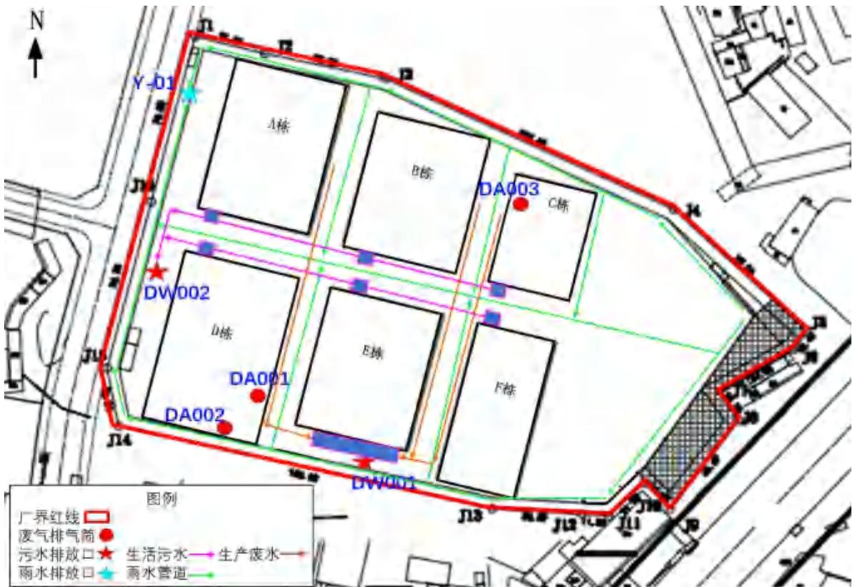
图3 本项目平面布置及雨污管网图
