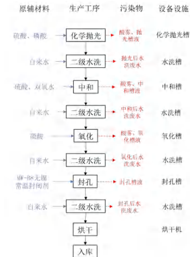
图 3.6-3 手动铝氧化线生产工艺及产污环节图
